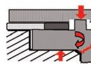
Durch einen zu großen Zylinderlaufbuchsenrückstand wackelt die Zylinderlaufbuchse im Sitz, was starke Schlagimpulse zur Folge hat.
