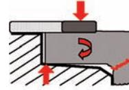
Die verwendete Zylinderkopfdichtung ist zu groß.
