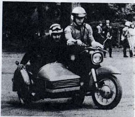
MZ-Seitenwagenschwinge in einer Linkskurve. Deswegen raten wir, den MZ-Seitenwagen nicht an schwere Motorräder anzuschließen.
