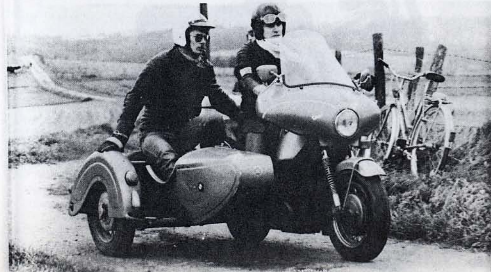
Die Linie, die die Aufstandspunkte von Vorderrad und Seitenwagenrad miteinander verbindet, kann in Linkskurven als Kippachse wirken. Das Seitenwagenrad des MZ Gespanns hat einen Vorlauf von 0,25 m.
