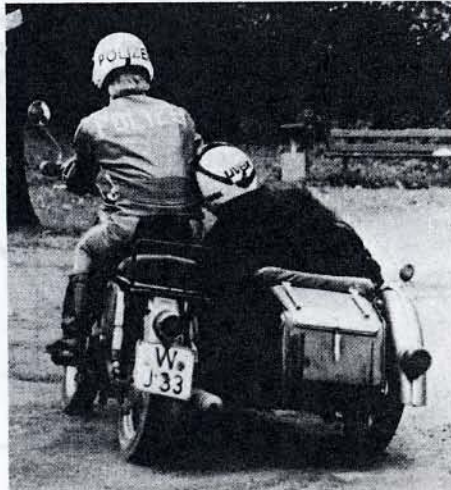
Auch Polizisten lernen Gespannfahren. Nach einer schnellen Linkskurve, die Seitenwagenfederung ist noch eingedrückt, steht der SW-Reifen noch neben der Felge.
